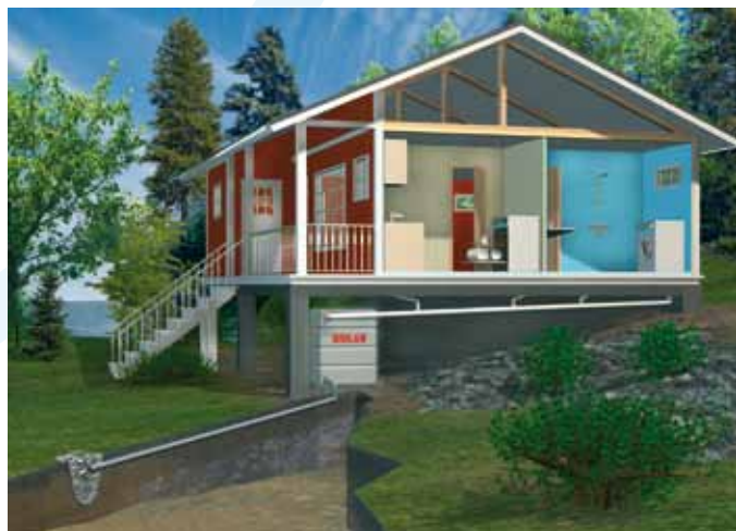
Сточная вода поступает в очистительную установку под действием силы тяжести.
