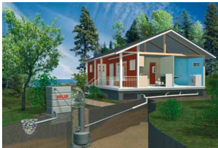
Очистительная установка с насосным комплектом Biolan.
